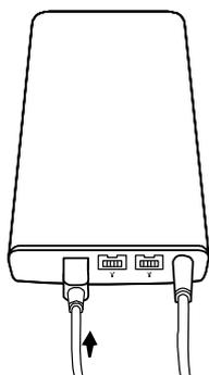
補充: 建議先將電源部份接好兩端後, 再接mini USB端, 可避免硬碟因為電力不足而起不來.
