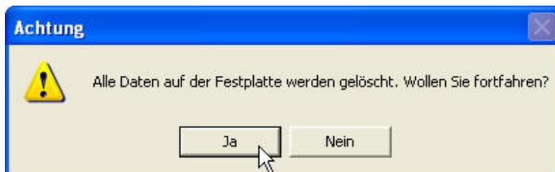
3. Die RAID MASTER Software wird nun den gewählten RAID Modus auf die Festplatten übertragen. Sobald der Prozess abgeschlossen ist, sollten „RAID Status“ und Festplatteninformation“ den neuen RAID Modus anzeigen. Sie können nun das RAID System mit dem gewünschten RAID Modus in Betrieb nehmen!
