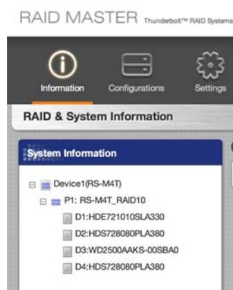
**RAID 設定:** 可設定一台或多台陣列機以上所做的 RAID 組。此畫面提供了陣列機、陣列機所設的 RAID 組現況、設立 RAID 模式、刪除 RAID 組、重建及所需要選擇的磁碟。每個置入的硬碟可以顯示個別容量。
