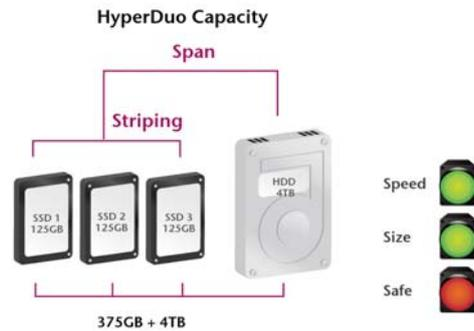
Safe 模式相對於 Capacity 模式，可以提供資料的安全性而不會降低讀取的速度。但是寫入的速度會較慢。Safe 模式運作的原理是將資料以 RAID 0 (Striping)到 SSD 中，同時以鏡射方式(Mirroring)存入相同的資料到 HDD 上。當 SSD 存滿後，剩下資料則以 Span 方式寫入到 HDD 上。當 SSD 故障，由於鏡射的資料在 HDD 上有備份，資料相對較安全。但是如果是 HDD 故障，資料將無法修復。
