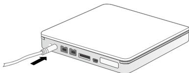
如果需要替換變壓器上的插頭，可以按圖示壓下卡榫，就可以將插頭卸下做更換。
