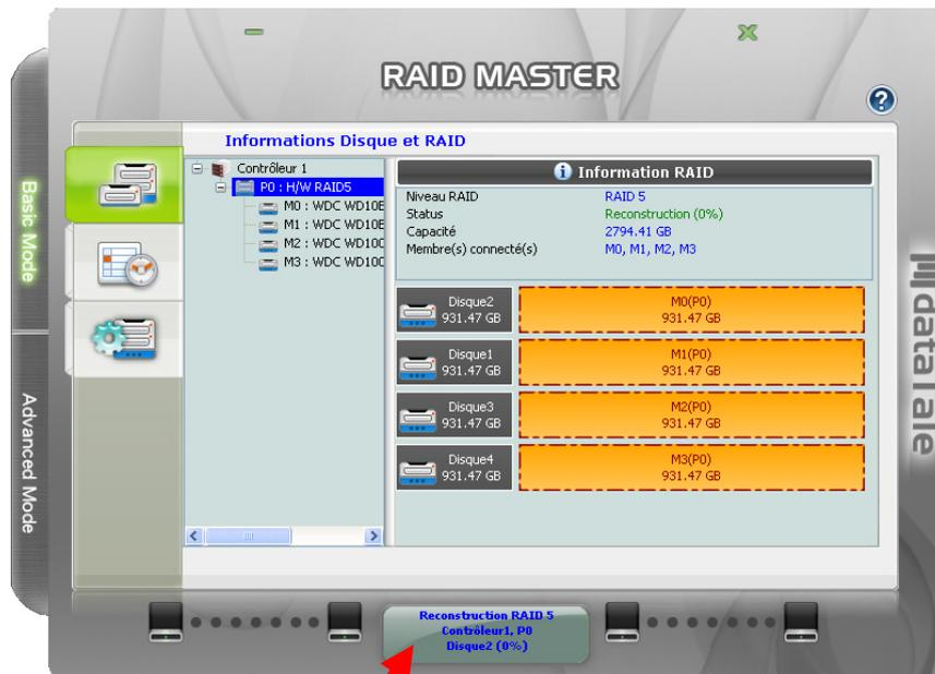
📌 La vitesse de reconstruction du modèle USB 2.0 est d'environ 200Go / heure soit environ 56.88 Mo / seconde. Lorsque le processeur effectue une tâche de reconstruction, si l'on tente d'accéder aux données pendant cette période, la vitesse d'accès dépendra de la priorité de reconstruction (réglée dans le menu du mode avancé). Dans tous les cas, l'accès aux disques pendant une opération de reconstruction n'est pas recommandé.
