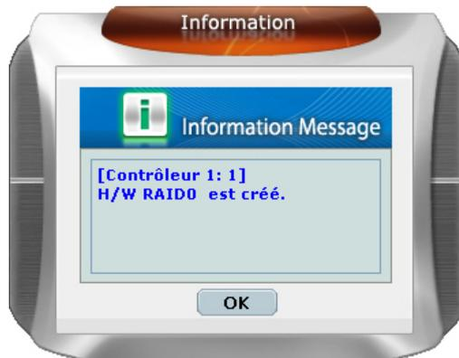
6. Les disques insérés reflèteront le Mode RAID assigné et le RAID MASTER affichera une simple information sur eux. Le Système RAID est maintenant prêt à être utilisé dans Mode RAID choisi!
